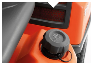
Tapón externo del depósito
